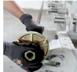
4 Closing & Clamping the battery mould Stänga och kläm ihop batteriformen
